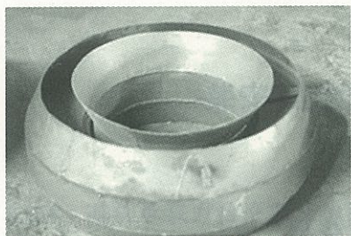
图 4.1.5-1 整体环形荷载箱
